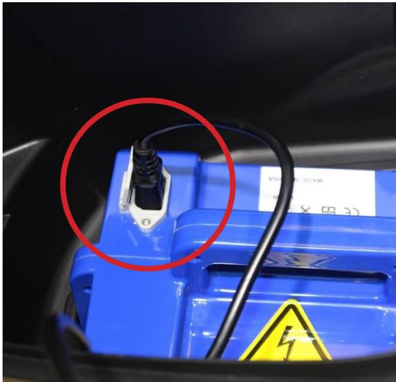
7. Jetzt erst das Verbindungskabel IEC C13 an der vorgesehenen Stelle an dem Akku anschliessen, dazu muß man die Abdeckung öffnen.
