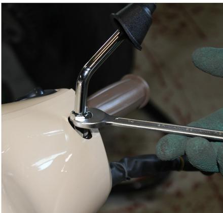
19. Schrauben Sie die Spiegel mit Hilfe des 14mm Ringschlüssels an.
