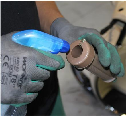
16. Um den Handgriff zu montieren, benutzen Sie ein wenig Wasser. Dies erleichtert die Montage.
