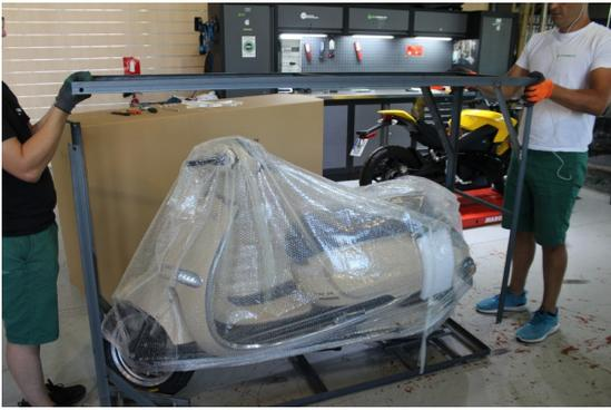
9. Heben sie nun die obere Metallkonstruktion ab und stellen diese zur Seite.
