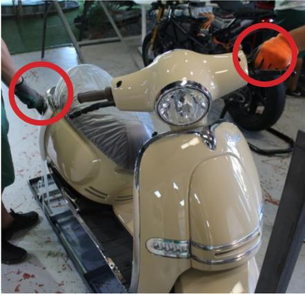
12. Wir empfehlen, den Roller zu zweit festzuhalten, während die Transport-Sicherungsänder an der Unterseite des Gestells durchtrennt werden.
