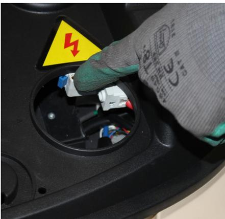
22. Schalten Sie die Hauptsicherung ein. Prüfen Sie, ob alle Lichter, Blinker sowie die Hupe funktionieren.
