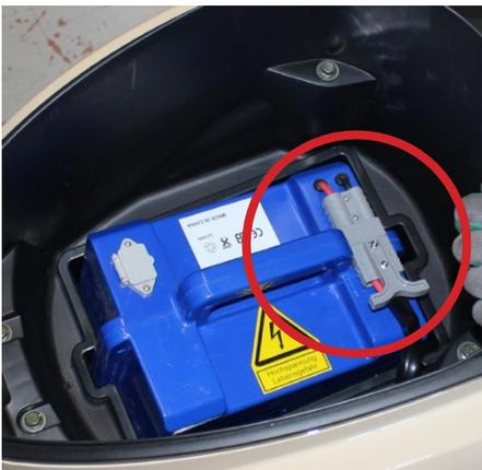
21. Schließen Sie die Batterie korrekt an.
