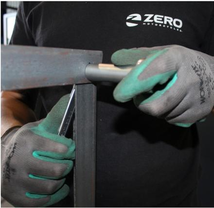
5. Setzen Sie die Schlüssel außen an und halten Sie von innen gegen.
