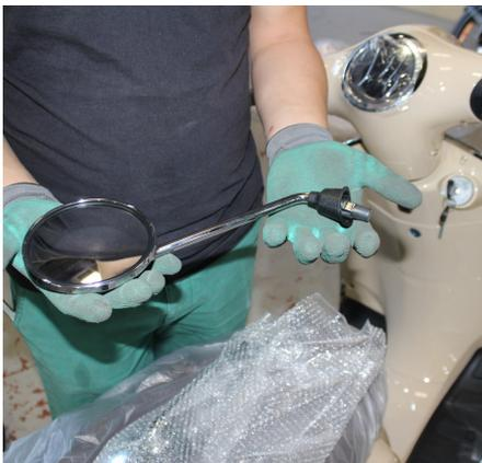
18. Entnehmen Sie die Spiegel und prüfen Sie diese auf Beschädigungen.
