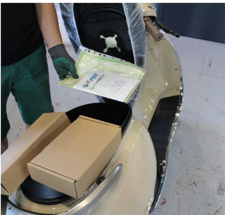
15. Öffnen Sie die Sitzbank und kontrollieren Sie, dass die Papiere, das Batterieladegerät, die Spiegel und der Handgriff sich darin befinden.
