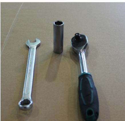
4. Für den nächsten Schritt benötigen Sie die 14 mm Ringschlüssel.
