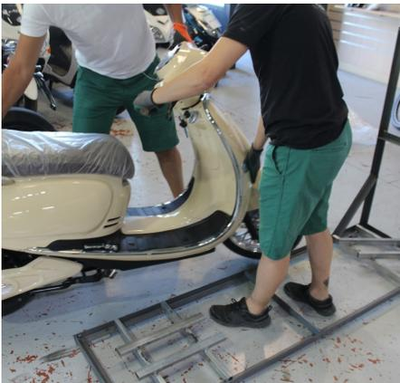
14. Schieben Sie den Roller zurück und heben Sie ihn vollständig aus dem Gestell heraus. Stellen Sie den Roller auf den Hauptständer.
